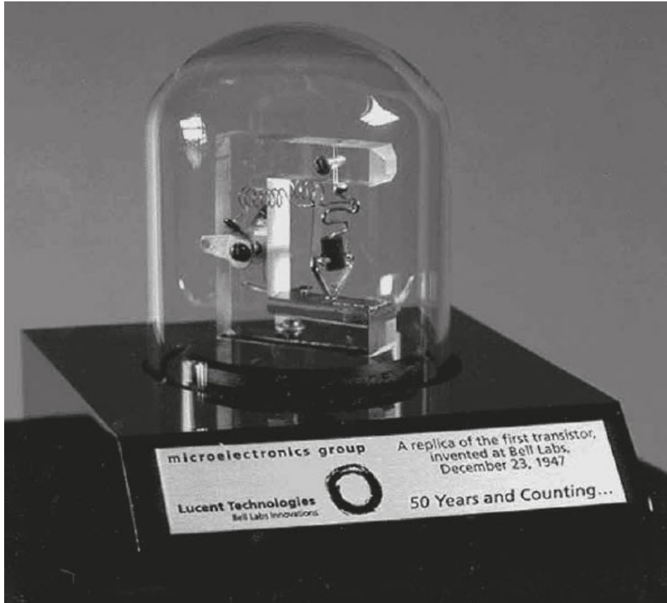
Réplica del primer transistor, de 1947.
