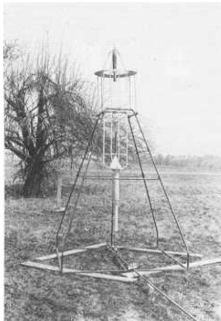
Figura 112a El primer cohete de combustible líquido que llegó a volar. Lanzado por Robert Goddard el 16 de marzo de 1926, desde la granja de su tía Effie en Auburn, Massachussets, su vuelo duró dos segundos y medio. (Cedida por la Biblioteca Goddard, Universidad Clark.)
